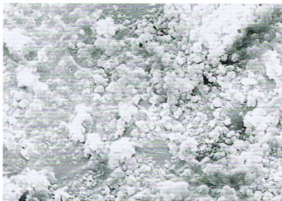
配管表面のバイオフィルム
